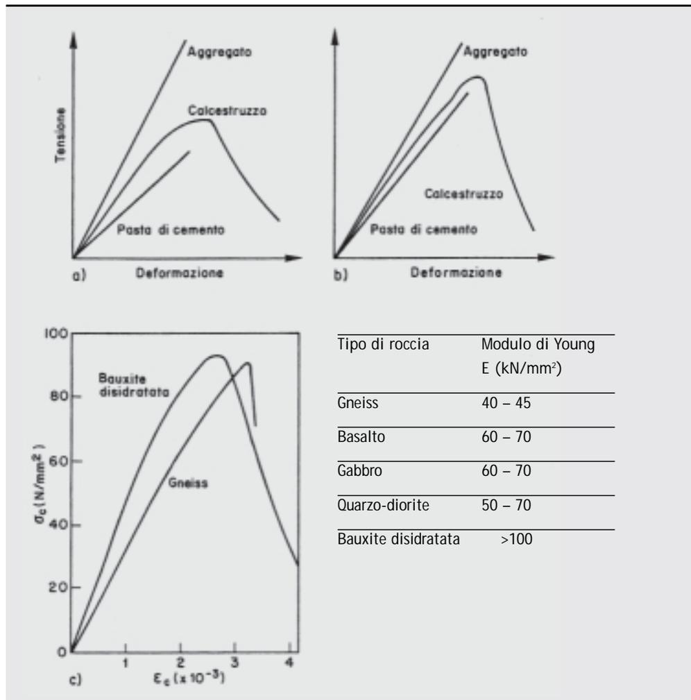
È provato che con i migliori aggregati naturali attualmente in uso per la produzione dei calcestruzzi ordinari sia possibile raggiungere resistenze fino a 130-140 N/mm<sup>2</sup>. Nella fascia degli alti valori di resistenza, l'aggregato è generalmente pietrisco, ottenuto da rocce dense e dure.
