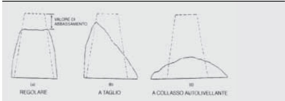
La prima forma, con abbassamento uniforme senza alcuna rottura della massa, indica comportamento regolare.
