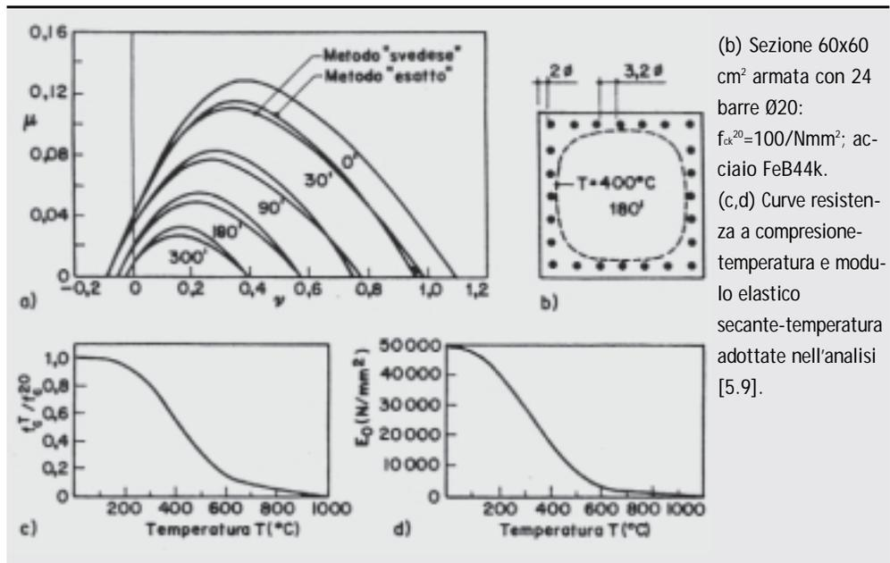
(b) Sezione 60x60 cm<sup>2</sup> armata con 24 barre Ø20:  $f_{ct}^{20}=100/N/mm^2$ ; acciaio FeB44k. (c,d) Curve resistenza a compressione-temperatura e modulo elastico secante-temperatura adottate nell'analisi [5.9].
