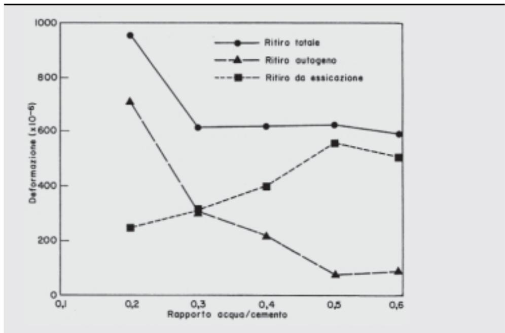
La cinetica di sviluppo del ritiro autogeno è controllata dalla velocità di idratazione, e poiché nei calcestruzzi AR si impiegano elevati contenuti di cemento a rapido indurimento, il ritiro autogeno comincia a manifestarsi già in fase di presa, per poi svilupparsi rapidamente e stabilizzarsi nel volgere di tre mesi circa. Il fenomeno può assumere un ruolo importante già nelle prime ore, quando la resistenza a trazione del materiale è molto modesta.
