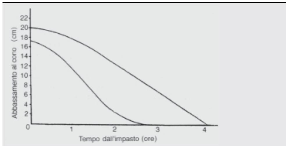
Accelerazioni della perdita di lavorabilità si possono verificare, senza variazioni del periodo di presa, con l'uso di additivi riduttori di acqua.
